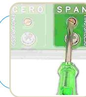
Ajustar mediante el potenciómetro de SPAN, hasta obtener en la salida 20,00mA.
