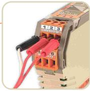
Desconectar el sensor Pt100, sustituyéndolo por el simulador, utilizando la conexión apropiada de 2-3 hilos.
