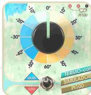
Seleccionar con el simulador el valor de INICIO Escala con el conmutador en temperaturas **▲** 0°C - INICIO
