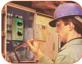
Es un elemento indispensable en el laboratorio, taller o en fábrica para calibrar y verificar convertidores, reguladores y toda clase de instrumentos con entrada Pt100, simulando una variación de temperatura.
