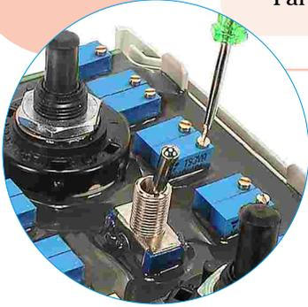
Permite recalibración independiente de cada valor de temperatura.
